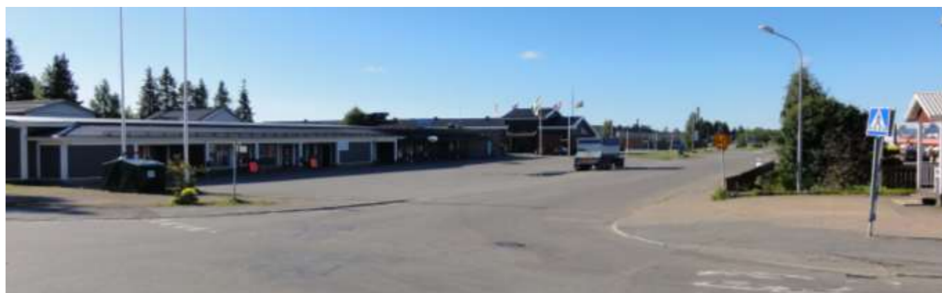
Exempel på brett och odefinierat gaturum utmed Kengisgatan. Parkeringen till vänster i bild saknar tydliga in- och utfarter från gatan. Sammantaget är detta en otrygg trafikmiljö, särskilt vid korsningen. Foto: Pajala kommun
