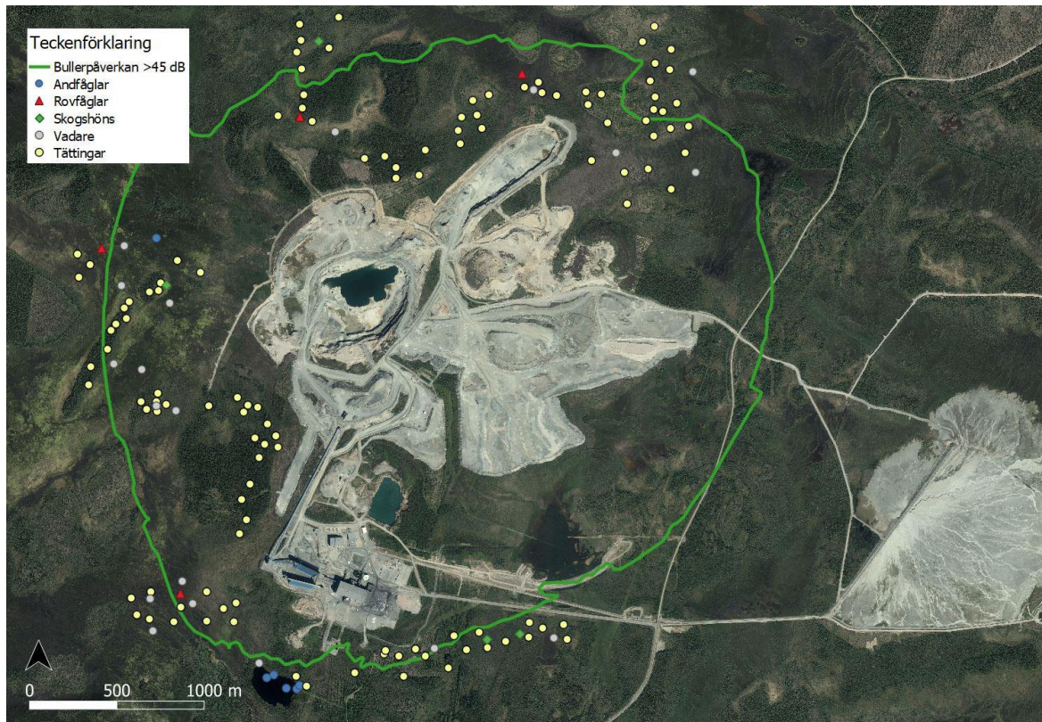
Figur 14. Tapuli gruva samt påverkansområdet för buller >45 dB samt noterade fåglar i samband med häckfågelinventeringen år 2019. Centralt i figuren ligger gruvanläggningen med dagbrott och gråbergssupplag, till höger (öster) ligger sand- och klarningsmagasin.
